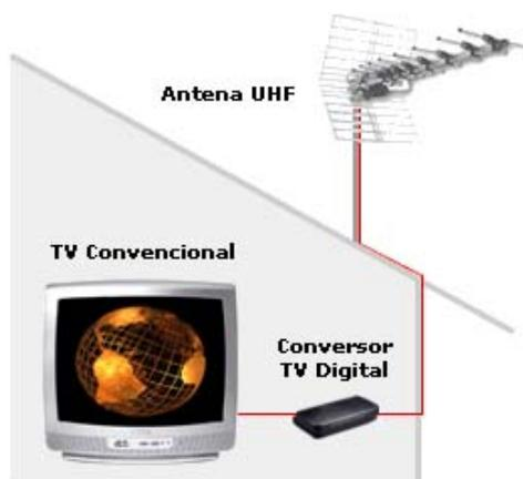
*Figura 3 : Itens necessários para a recepção do sinal digital, destaque ao conversor.*
